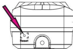
**5.2.** En caso de que el lector presente problemas o no responda, puede reiniciarlo con el botón de reset que está ubicado en la parte inferior izquierda del dispositivo. Utilice una herramienta fina con un diámetro menor a 2mm.
