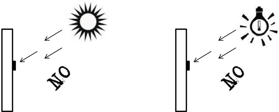
**5.1.** Por ser un sensor óptico, el lector es afectado por la luz directa del sol o luz artificial intensa cercana. Evitar instalarlo bajo estas condiciones de iluminación.
