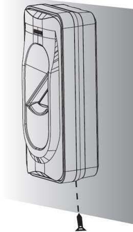
**1.5.** Colocar el lector en el montaje metálico y tensar el tonillo de la parte inferior firmemente.
