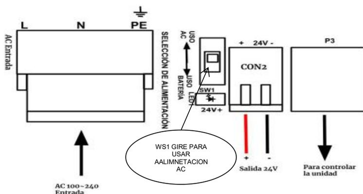
Esta barrera puede ser alimentada por una batería de 24V en el área sin suministro eléctrico. Conexión como fuente.
