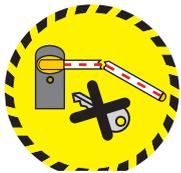
**¡PRECAUCIÓN!** La operación de desbloqueo podría representar un peligro para el usuario cuando, por algún motivo como por ejemplo, mástil fijado incorrectamente en el alojamiento durante el montaje, mástil arrancado o quebrado debido a un accidente etc., los muelles en tensión, no garantizan más el balanceado. Estos podrían provocar por lo tanto una brusca rotación del enganche del mástil y/o del mástil mismo.
