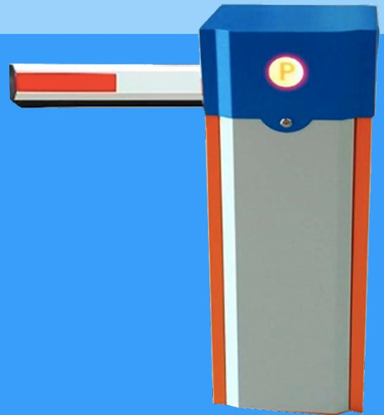
Esta es la barrera vehicular más reciente de Wejoin con servomotor de CD. Utiliza electrónica avanzada con tecnología de control y procesamiento, eliminando piezas de calibración como el interruptor de límite, evitando servicios de ajuste al mecanismo, la velocidad es ajustable con la opción de reducir la velocidad automáticamente. De esta manera, haga que la barrera opere de manera más constante y real.
